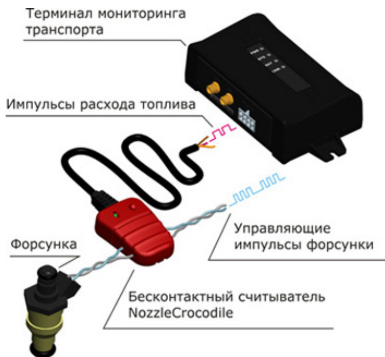
Рисунок 1 – Схема подключения NozzleCrocodile Характеристики выходного сигнала:
